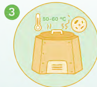
Fermentasi Dalam Wadah Kompos (Anaerob & Semi-Aerob) Masukan Reaktor, tambahkan bio-aktivator. Suhu naik 50-60C
